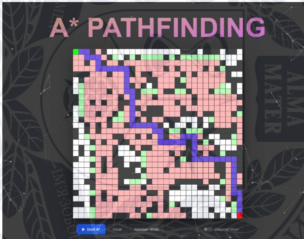
Рисунок 1.1 – Візуалізація роботи алгоритму A* на сітці 30×30: зелений — відкритий список, червоний — закритий, синій — знайдений шлях
