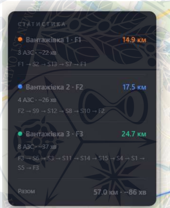
Рисунок 3.6 – Статистична панель після завершення оптимізації: відстані, порядок відвідування та розрахунковий час для кожної вантажівки
