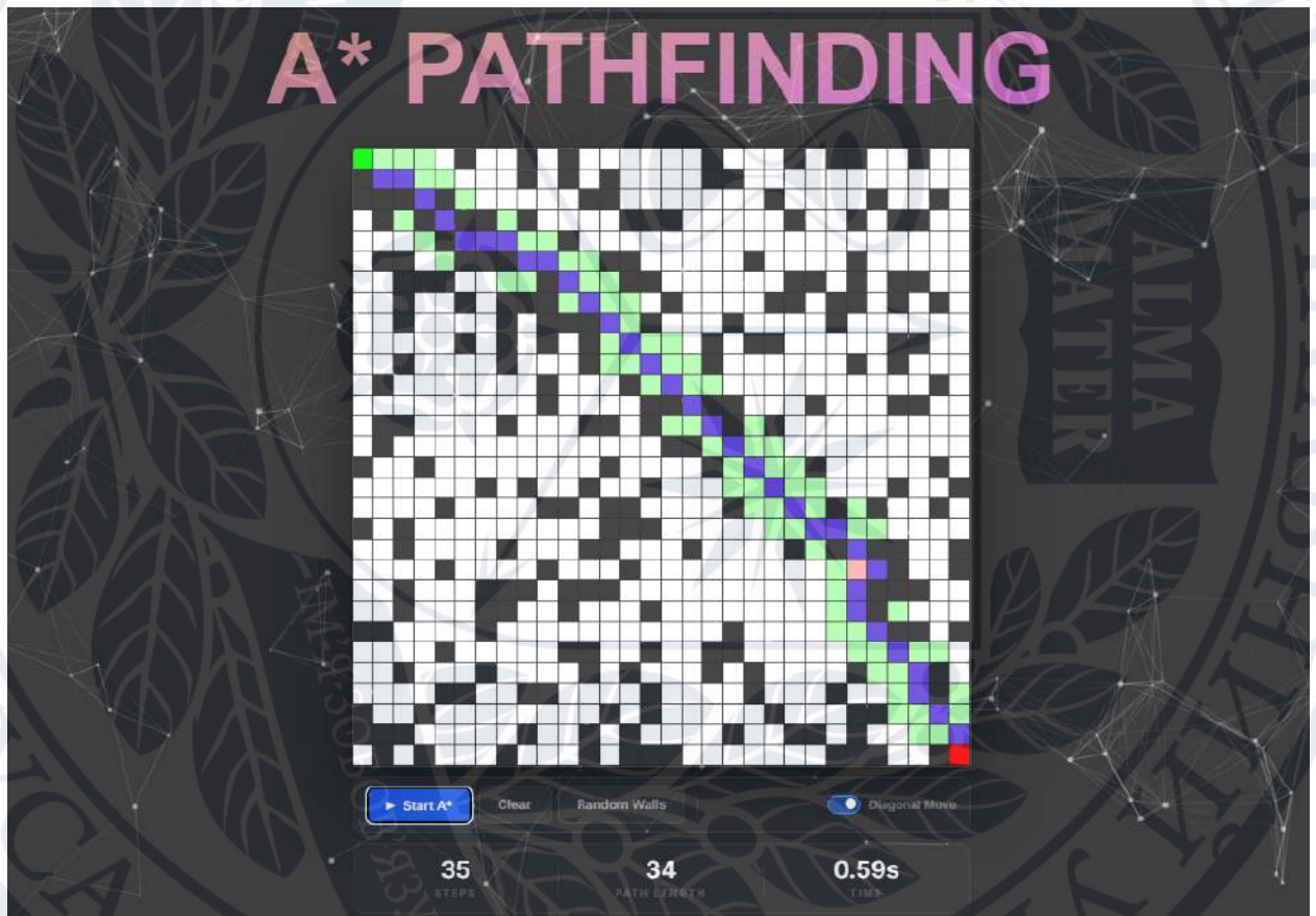
Рисунок 3.2 – Демонстрація A^* (astar.html): сітка 30×30 із перешкодами та знайдений шлях у діагональному режимі
