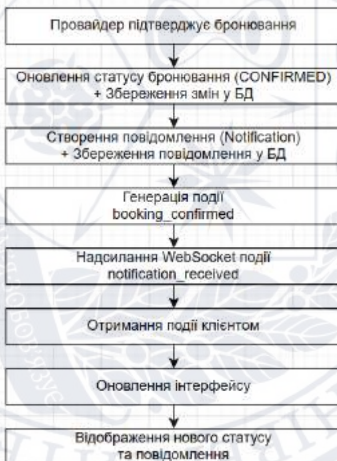
Рисунок 3.29 – Процес обробки події підтвердження бронювання та доставки повідомлення клієнту
