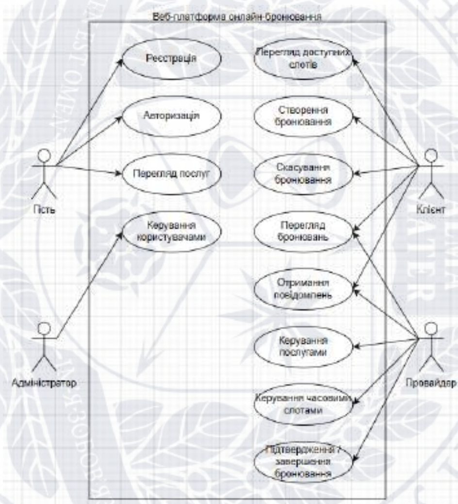
Рисунок 2.2 – Діаграма варіантів використання веб-платформи онлайн-бронювання
