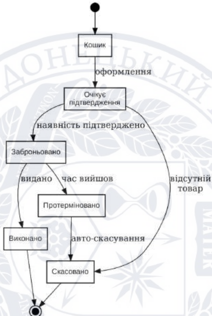
Рисунок 1.5 – Діаграма станів замовлення у системі e-pharmasy
