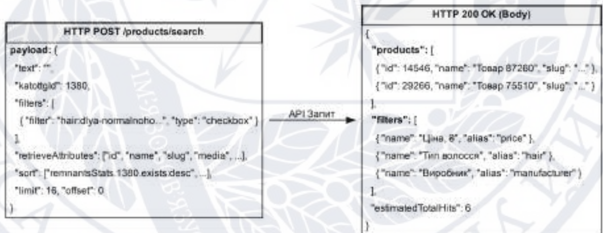
Рисунок 3.1 – Структура запиту та відповіді модуля фасетного пошуку
