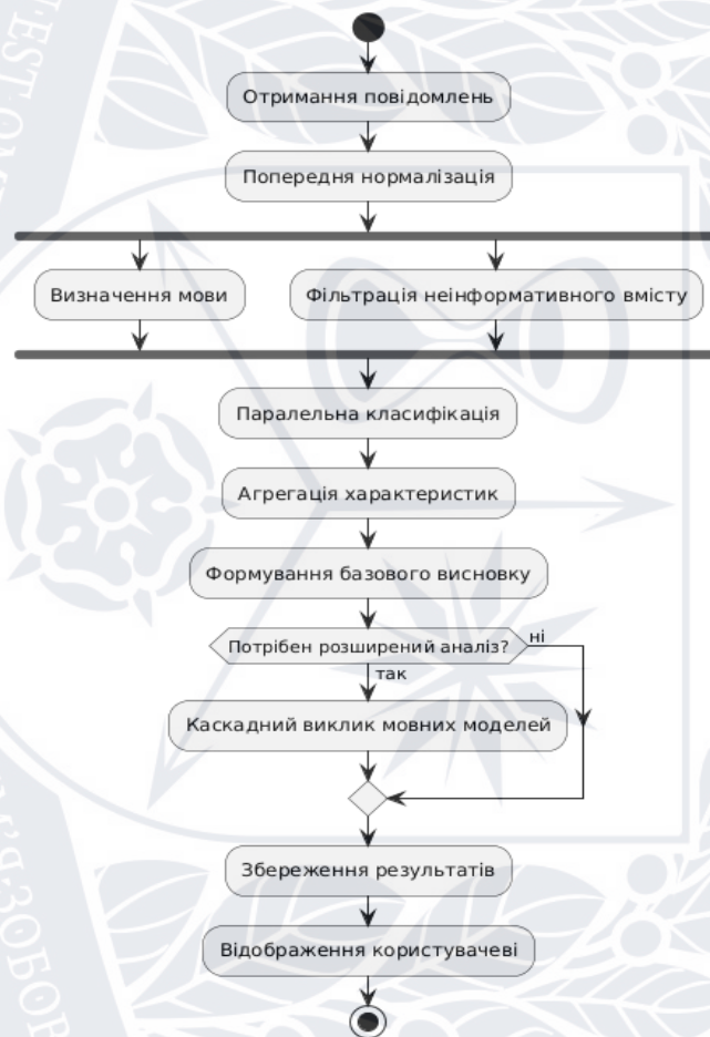
Рисунок 2.6 – Конвеєр обробки текстових повідомлень
