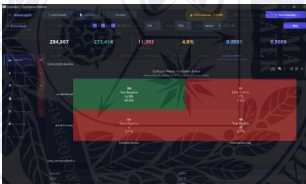
Рисунок 3.8 – Вкладка Confusion Matrix для Isolation Forest: TN=14 392 (95,9 %), FP=572 (3,8 %), FN=8 (0,1 %), TP=28 (0,2 %); Precision=0,0467, Recall=0,7778, F1=0,0881
