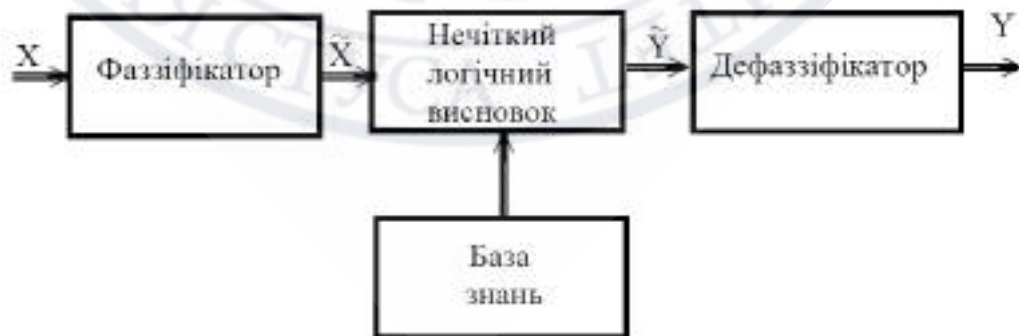
Рисунок 2.7 – Структурна схема системи НЛВ [17]
