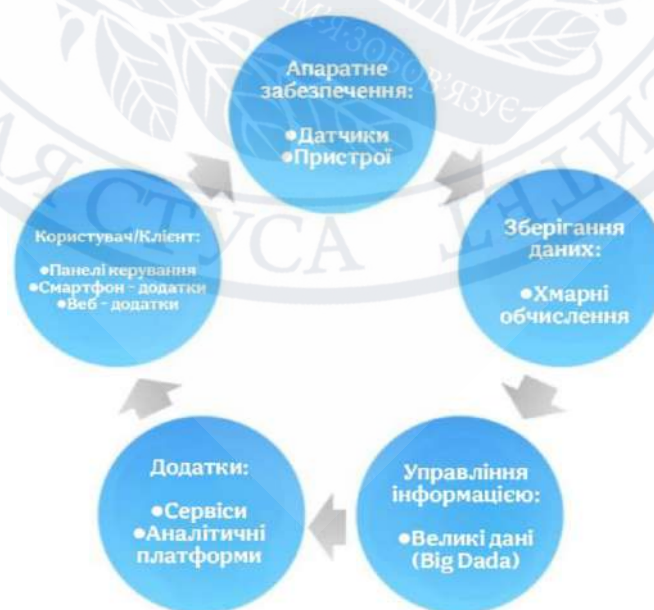
Рис. 1.1. Спрощена схема архітектури IoT в системі Smart City (від збору даних до прийняття рішень).
