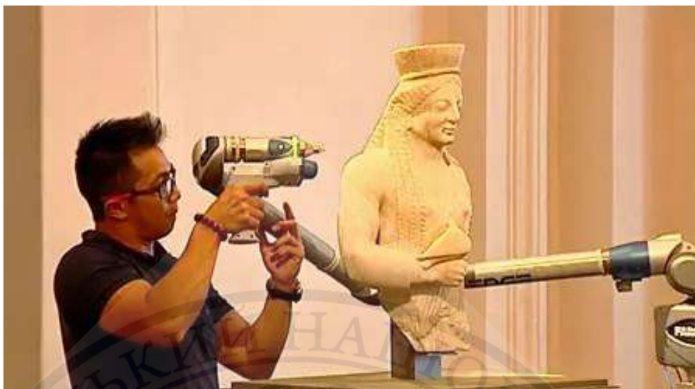
Рисунок 2.6 – Член Arscan сканує в 3D статую за допомогою 3D-сканера FaroArm
