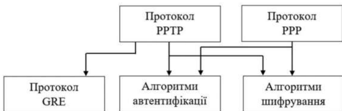
Рисунок 1.4 – Архітектура протоколу PPTP
