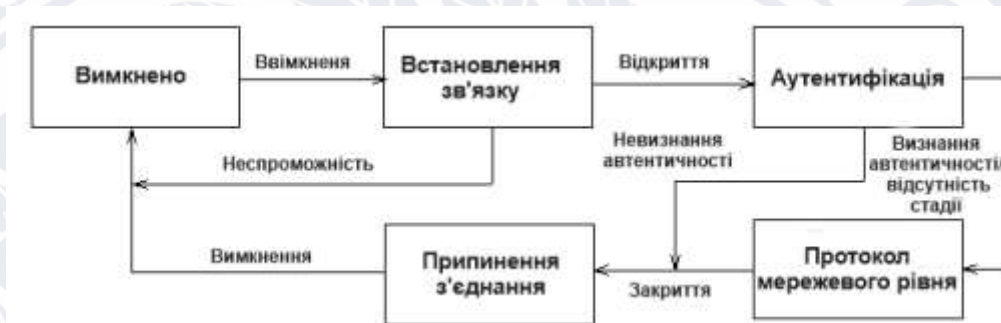
Рисунок 1.3 – Діаграма станів протоколу PPP
