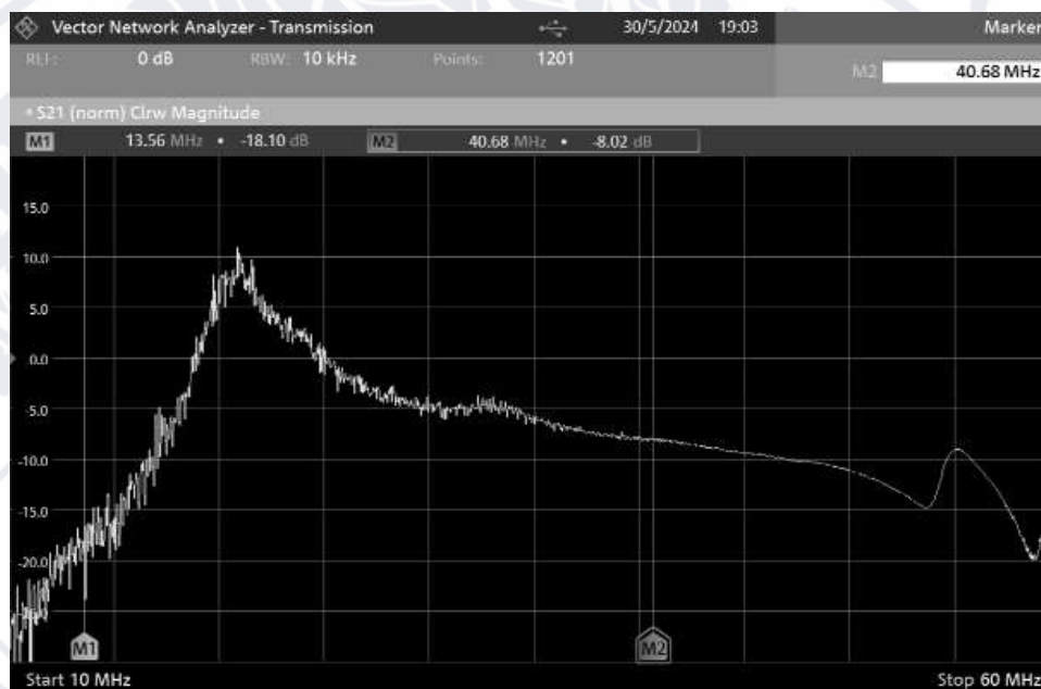
Рисунок 3.13 – Результат вимірювання передаточної функції для 1 та 3 гармоніки для ретранслятора без заземлення та без шунтувального контуру
