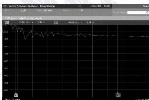
Рисунок 3.22 – Результат вимірювання коефіцієнту передачі для установки з ретранслятором з шунтувальним контуром, до якого приєднано резистор на 10 Ом та зі збільшеним екраном
