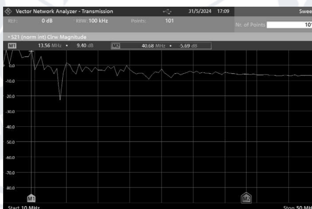
Рисунок 3.23 – Результат вимірювання коефіцієнту передачі для установки з ретранслятором з шунтувальним контуром, до якого приєднано резистор на 100 Ом та зі збільшеним екраном
