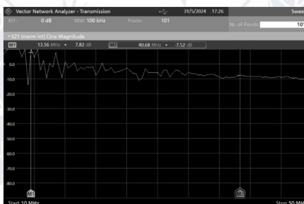
Рисунок 3.25 – Результат вимірювання коефіцієнту передачі для установки з ретранслятором з шунтувальним контуром, до якого приєднано резистор на 100 Ом та зі збільшеним екраном при значно збільшеній відстані між котушками передачі та прийому
