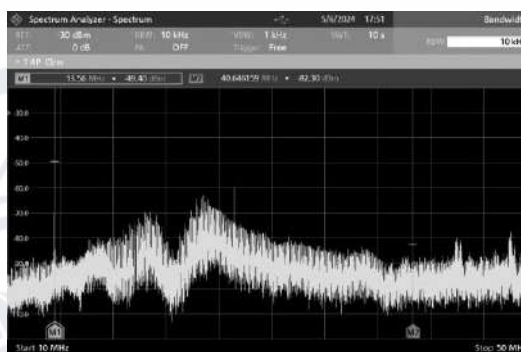
Рисунок 3.30 - Вимірювання потужності сигналу для установки з ретранслятором між котушкою передачі та карткою з одного боку та рідером з іншого
