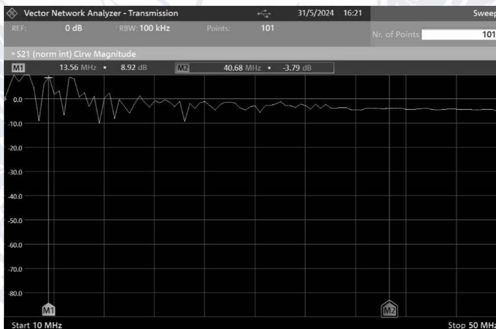
Рисунок 3.21 – Результат вимірювання коефіцієнту передачі для установки з ретранслятором з шунтувальним контуром, до якого приєднано резистор на 1 Ом та зі збільшеним екраном
