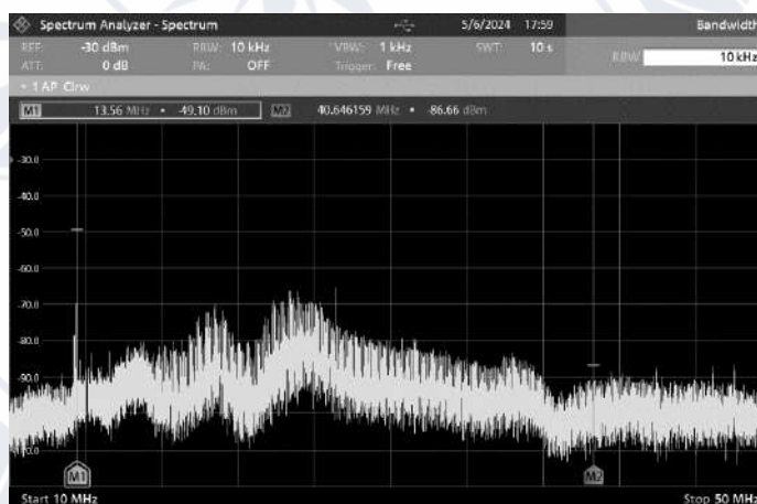
Рисунок 3.29 – Вимірювання потужності сигналу для установки з ретранслятором між котушкою передачі з одного боку та рідером з картою з іншого
