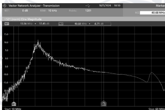
Рисунок 3.12 – Результат вимірювання передаточної функції для 1 та 3 гармоніки для ретранслятора без заземлення з приєднаним шунтувальним контуром
