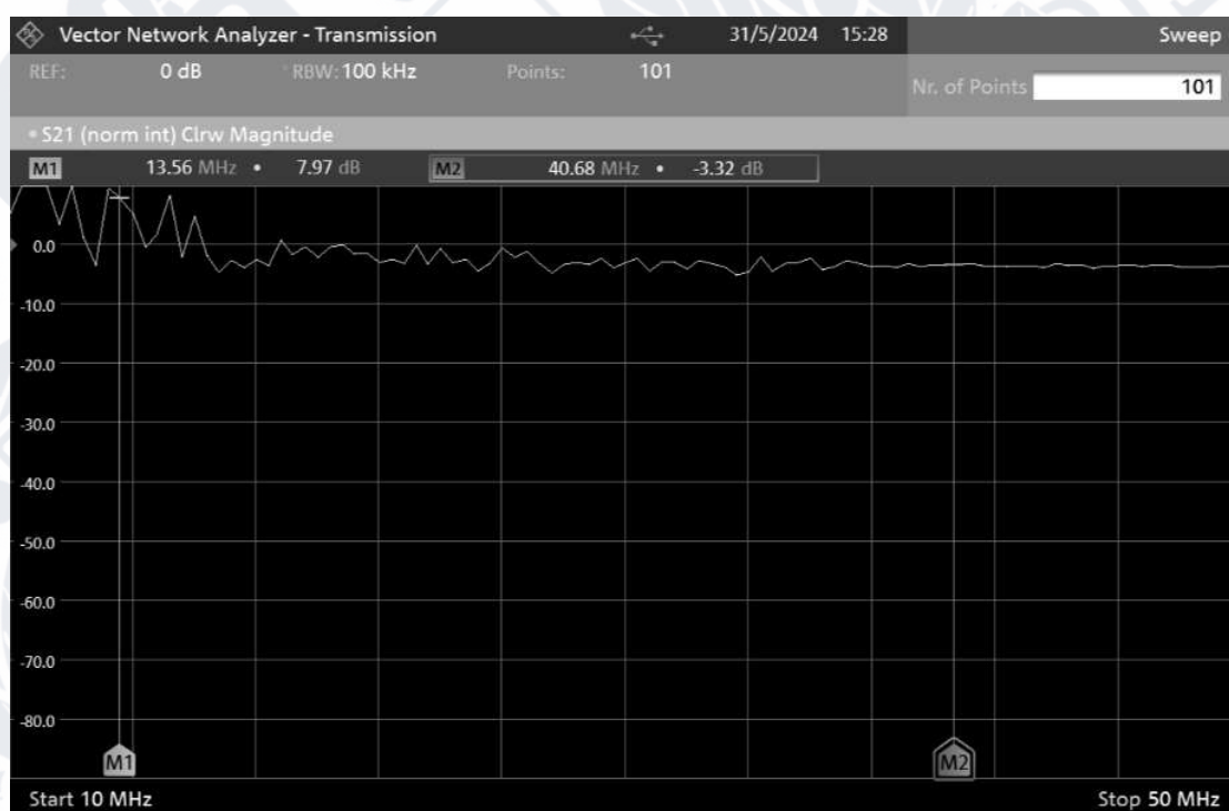
Рисунок 3.19 – Результат вимірювання коефіцієнту передачі для установки з ретранслятором без шунтувального контуру та зі збільшеним екраном
