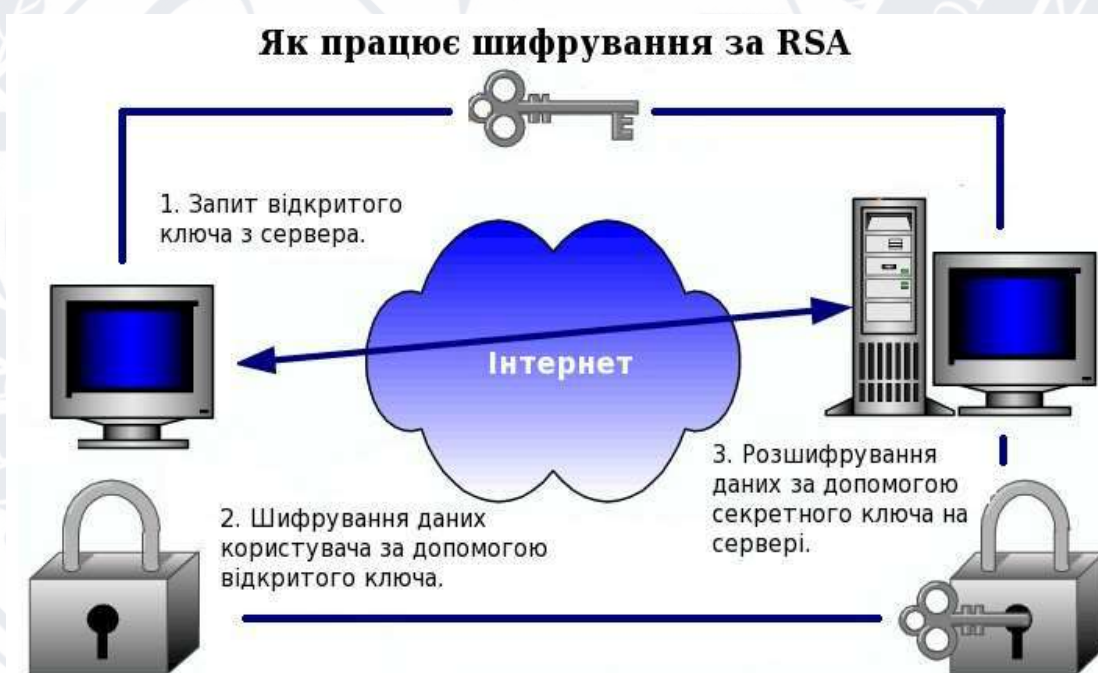
Рисунок 2.1 – Приклад, як працює шифрування за RSA
