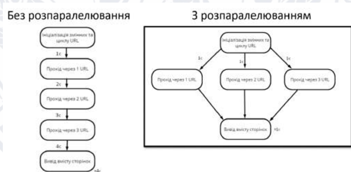
Рисунок 2.8 - Принцип розпаралелювання запитів API
