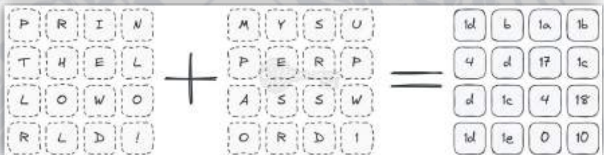
Рисунок 1.3 – Операція перетворення “state matrix” та 128 bit ключа у шифр
