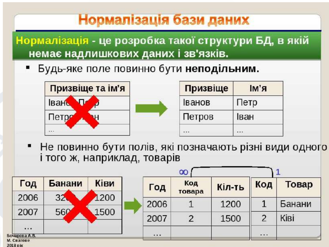
Рисунок 2.4 Приклад роботи нормалізації БД
